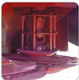
El sistema de corte modular de discos con doble cuchilla reversible, realiza un corte uniforme sin dañar la planta obteniendo mejor calidad y mayor rebrote de forraje. La versatilidad de estas maquinas permite utilizarlas en cualquier condición de trabajo con muy bajo costo de operación y mantenimiento con una alta velocidad de corte.
