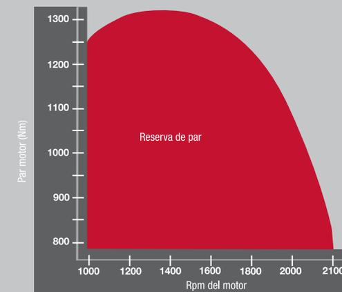
Esta curva muestra claramente cómo el par máximo se mantiene entre 1.200 y 1.500 rpm, con un aumento del par motor a medida que las rpm bajan entre 2.100 y 1.500 rpm para una mayor capacidad de par y velocidad de la TDF constante.
