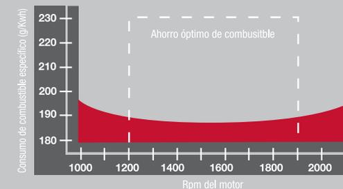
El sistema de gestión electrónica del motor de los modelos MF amplía el rango de funcionamiento dentro del cual el tractor trabaja con una eficiencia óptima del consumo de combustible.
