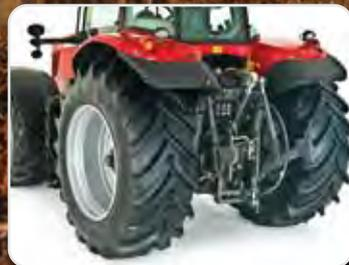
Los botones adicionales de arranque/parada de la TDF montados en el guardabarros permiten usar la TDF desde fuera de la cabina. También puede controlar las rpm del motor con el botón de inicio/parada de la TDF, una función que resulta perfecta, por ejemplo, al usar un depósito de líquidos.
