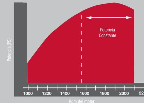
Esta curva muestra claramente el alto rendimiento del motor, con una "potencia constante" mantenida a 1.570 rpm.
