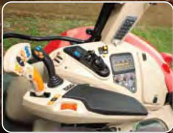
Los pulsadores de selección de velocidad de la TDF, selector de la TDF y accionamiento automático están cómodamente situados en el panel derecho y resultan fácilmente accesibles para el operador.
