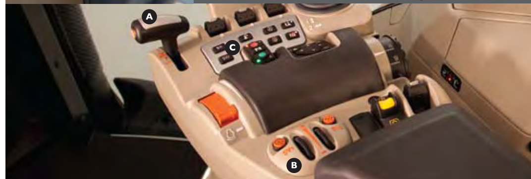
A. Palanca Dyna VT. B. Memorias de velocidades de SV1/SV2, modo de funcionamiento de Dyna-VT y selección de gama. C. Acoplamiento de SV1/SV2.
